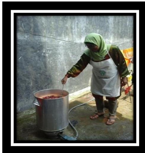
Gambar 3: Proses merebus untuk menghilangkan lilin
