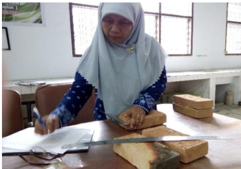
Gambar 2. Pengukuran Batu Bata Dengan Jangka Sorong
