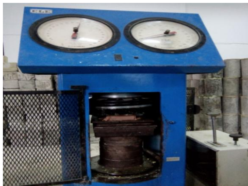
Gambar 3. Alat Uji Manometer Untuk Uji Kuat Tekan
