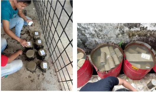
Gambar 3. (a) Beton Dalam Cetakan Silinder (b) Perendaman Beton
