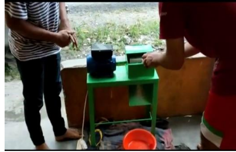
Gambar 6. Pengujian Memarut Ubi Kayu
