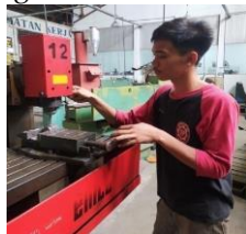
Gambar 4. Proses Drill Dudukan Sumbu
