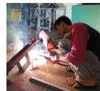
Gambar 8. Proses Pengelasan Plat Strip 10 mm
