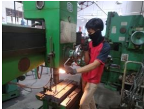
Gambar 3. Proses Drill Plat Dudukan Sumbu
