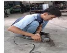
Gambar 7. Pemotongan Besi Siku 40 \times 40 \times 3 mm
