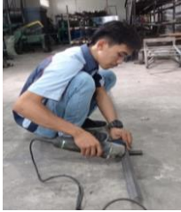
Gambar 2. Pemotongan Besi Siku 30 \times 30 mm
