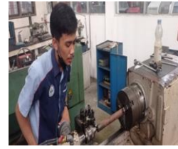
Gambar 5. Proses Pembubutan Sumbu Utama
