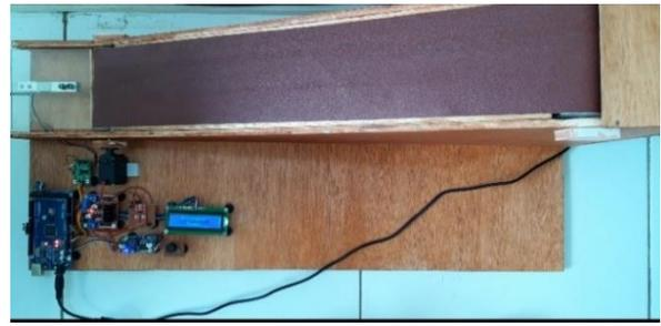
**Gambar 3.** Bentuk Fisik Miniatur Eskalator
