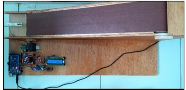
**Gambar 3.** Bentuk Fisik Miniatur Eskalator
