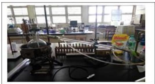
**Gambar 3.** Proses Destilasi Sederhana
