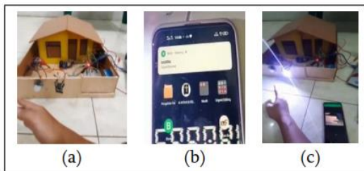
Gambar 2. Pengujian Blynk pada ESP32Cam dan Sensor PIR
