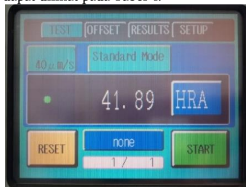
Gambar 4. Tampilan hasil uji kekerasan menggunakan alat ukurnya
