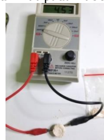
Gambar 6. Tampilan nilai uji kapasitansi dengan alat ukurnya
