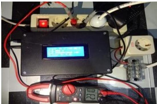
**Gambar 5.** Pengujian sensor tegangan
