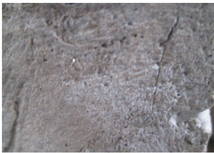
Gambar 7. Pembakaran suhu 500°C selama 3 jam. Beton pasir merah 62,5%
