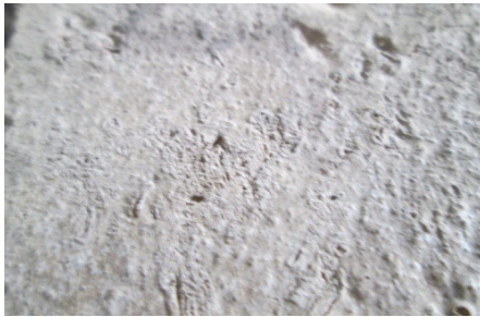
Gambar 7. Pembakaran suhu 500°C selama 3 jam. Beton pasir merah 62,5%
