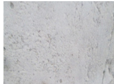
Gambar 3. Beton Normal tanpa pembakaran
