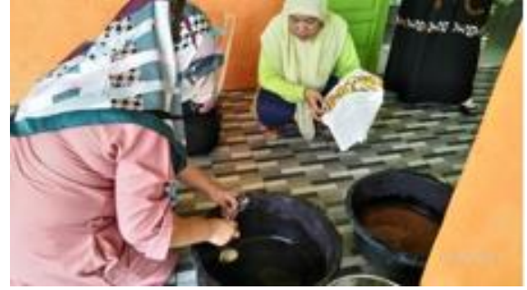
Gambar 24. Peragaan oleh Instruktur kepada Peserta saat Mencampur Warna dengan Air Mendidih untuk Persiapan Proses Mcelup Kain
