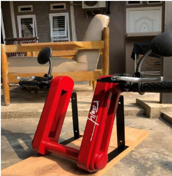
Stang Rawit memiliki dimensi P x L x T: 300.00 mm x 70.03 mm x 60.10 mm dengan menggunakan *Fiber Reinforced Polymer* (FRP) sebagai material utama, aluminium sebagai material pipa dan pin, dan menggunakan *rubber* pada bagian aksesoris seperti *handgrip*. Stang Rawit juga dilengkapi dengan sistem bongkar pasang dengan adanya pin di beberapa bagian stang dan sistem *adjustable* pada stem untuk mengatur sudut kemiringan stang.
