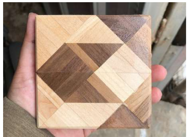
Gambar 8. Hasil Akhir Finishing Tiga Kali Lapis.
