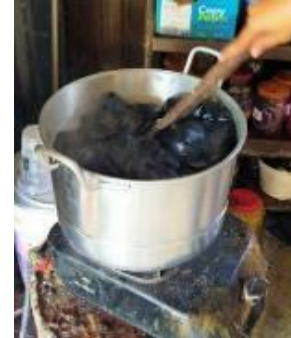
Gambar 6. Proses melorod atau menghilangkan malam
