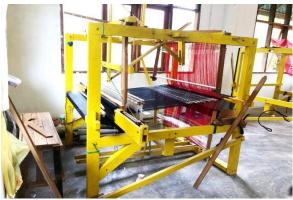
Gambar 1. Alat Tenun Bukan Mesin (ATBM)
