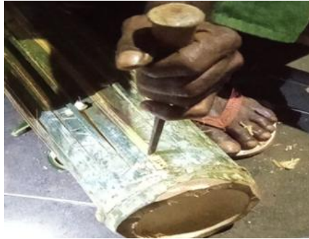
Gambar 6. Pembuatan Lubang Resonansi Bunyi Sumber: Peneliti, April 2024
