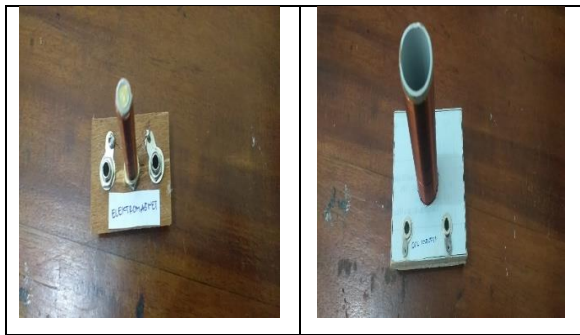
Gambar 7. Alat praktikum elektromagnet (kiri) dan alat praktikum GGL induksi (kanan)
