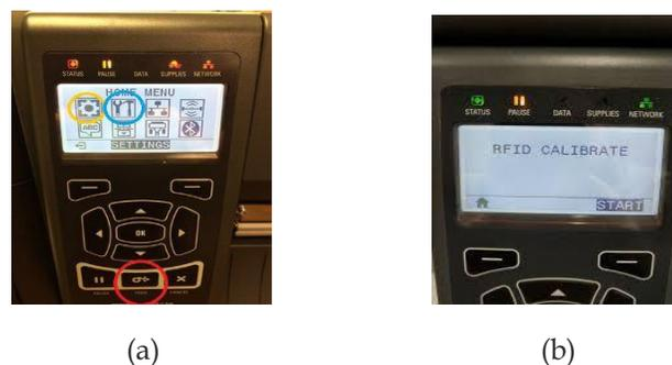
Gambar 5. (a) Tampilan Menu Printer RFID Zebra 410R, (b) Tampilan untuk Kalibrasi RFID
