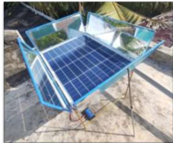
Gambar 4. Solar Panel dengan Instalasi Reflektor.
