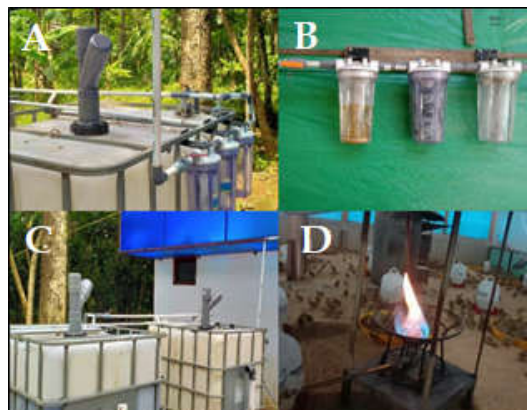
Gambar 5. Pemanas Kandang Ayam Pedaging Berbasis Biogas di Desa Sadamantra
