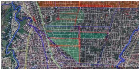
Gambar 6. Daerah tangkapan hujan (Catchment Area) Jalan Saudara
