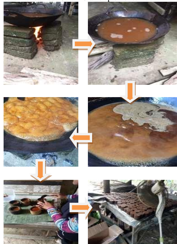
Gambar 2. Proses Produksi Gula Merah Berbahan Baku Nira Kelapa Sawit.
