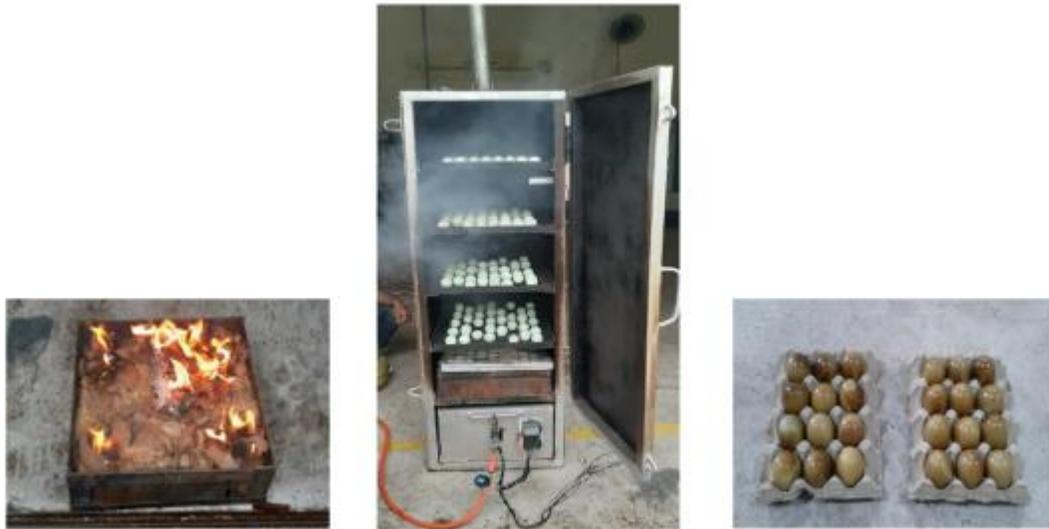
**Gambar 4.** Proses uji coba pengasapan telur asin di Laboratorium Teknik Universitas Buana Perjuangan Karawang
