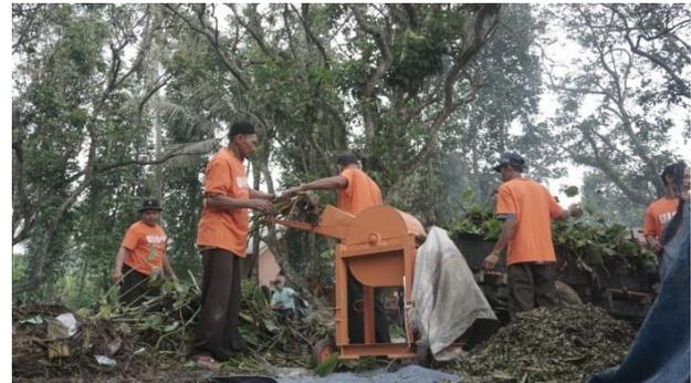
**Gambar 3.4** Pencacahan Enceng Gondok dengan Mesin Cacah
