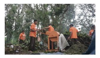
Gambar 3.4 Pencacahan Enceng Gondok dengan Mesin Cacah
