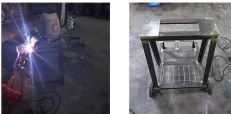
**Gambar 3.** Rangka Mesin
