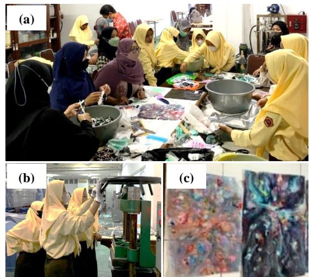
**Gambar 3.** (a) Siswa menyiapkan bahan baku untuk proses hot press. (b) Siswa diajarkan untuk memproses pada mesin hotpress secara mandiri. (c) Lembaran plastik dari limbah masker hasil dari proses *hot press*.
