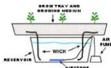
Gambar 2. Modifikasi hidroponik untuk akuaponik dengan sistem sumbu (Lee et al , 2010).
