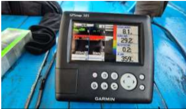
Gambar 9. Peralatan GPSmap yang dilengkapi dengan sensor echosounder
