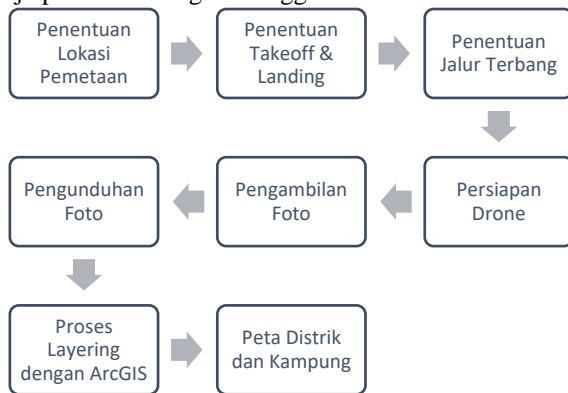
Gambar 2. Kerangka Kegiatan Pemetaan Geospasial dengan Drone
