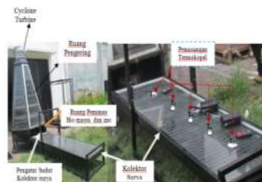
Gambar 1. Skema peralatan pengering tenaga surya Penampang pelat absorber dengan riblet ditunjukkan pada gambar 5.2.
