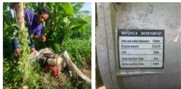
**Gambar 3.** Pompa air berbahan bakar bensin yang dipergunakan petani untuk mengairi sawah
