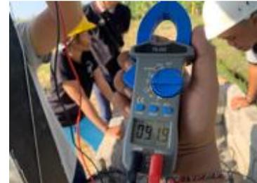
**Gambar 12.** Pengukuran tegangan open sirkuit empat buah modul
