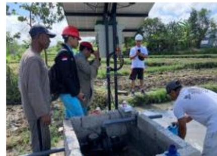
**Gambar 19.** Pengukuran debit air output pompa
