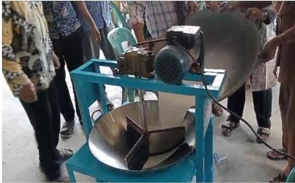
**Gambar 9.** Adonan dodol dimasukkan kedalam wadah mesin pengolahan
