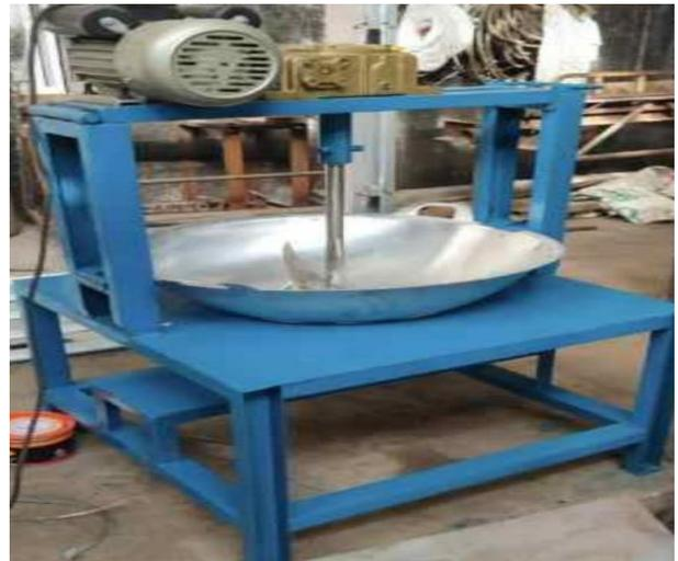
**Gambar 3.** Alat Mesin Pengolah Adonan
