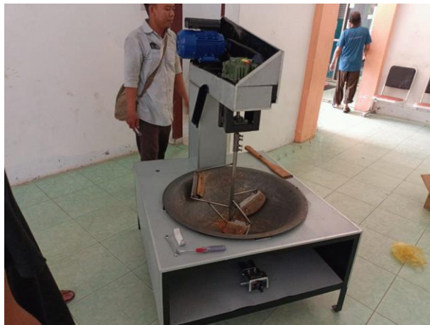
Gambar 2. Mesin Pemasak dan pengaduk nira nipah
