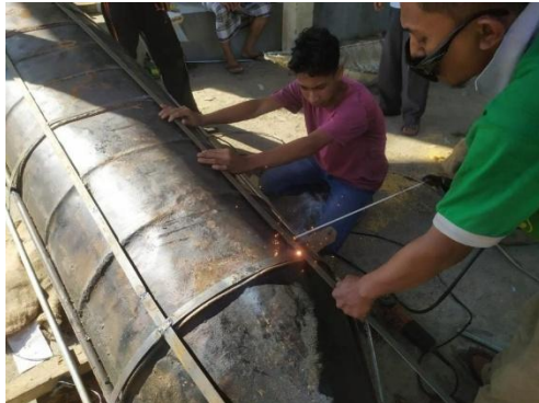
Gambar 2. Proses pembuatan rangka perahu sampan dengan penyambungan las
