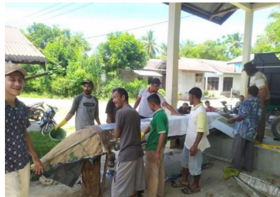
Gambar 5. Proses pemolesan resin pada serat fiberglass dan goni bekas perahu sampan
