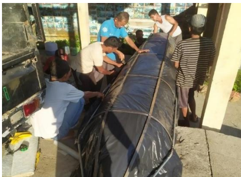
Gambar 3. Penempatan rangka perahu sampan pada cetakan
