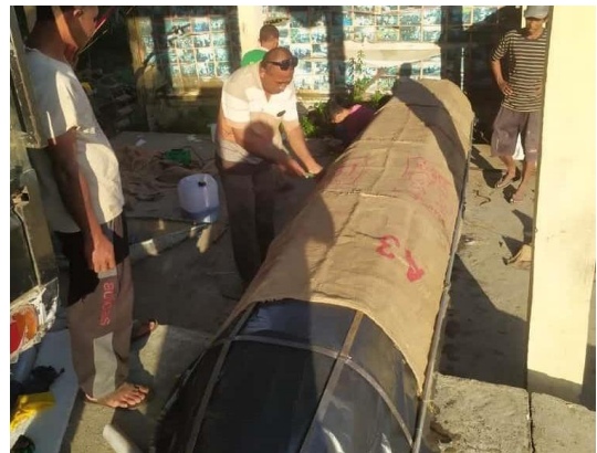
Gambar 4. Proses penempatan serat goni bekas pada rangka perahu sampan
