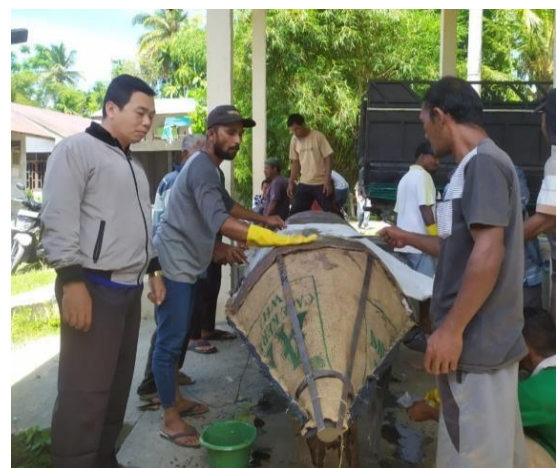
Gambar 6. Proses pelapisan serat pada haluan perahu sampan
