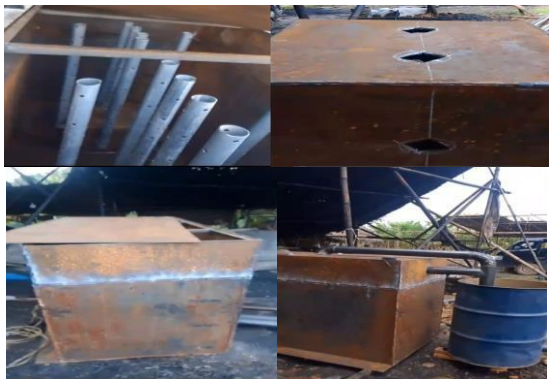
Gambar 3. Proses Peraitan alat Pirolisis Kondensasi di lokasi mitra
