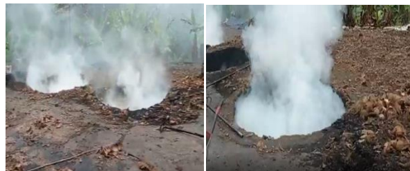
Gambar 2. Sumur-Sumur Pembakaran arang Batok kelapa yang sistem terbuka
