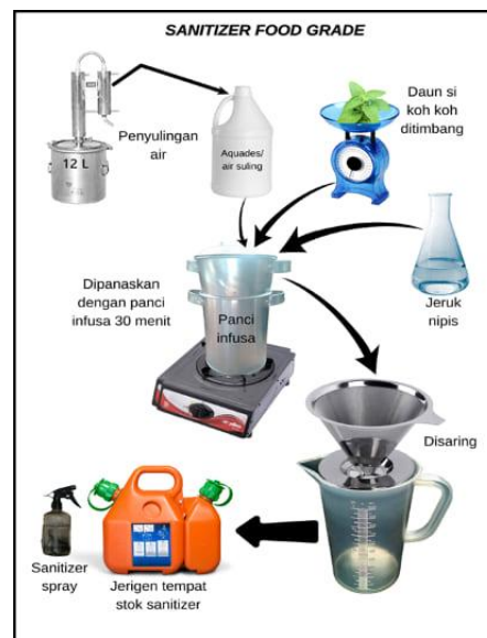
Gambar 1. Skema teknologi sederhana pembuatan sanitizer alami food grade berbahan dasar daun si koh koh
