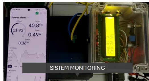
Gambar 3: Monitoring Daya IoT dan Blink pada PLTS
