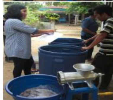
Gambar 5. Gambar proses penggilingan kulit jengkol
