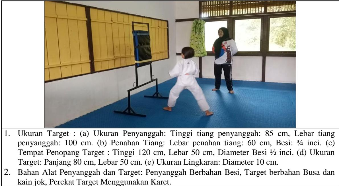
Gambar 1. Gambar dan spesifikasi Pengembangan Alat Punching Pad INKR 29 untuk Latihan ketepatan pukulan gyaku tsuki Karate Pemula.
