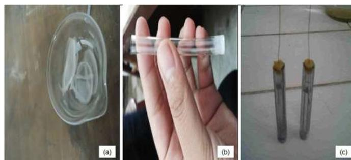
Gambar 3. Pembuatan ion selektif elektode merkuri dengan memadukan membran elektroda di dalam pipa paralon: (a) Membran elektroda yang mengandung senyawa aktif ionofor **DTODC**, (b) Bodi elektroda terbuat dari pipa paralon, (c) Bentuk ISE-Hg.
