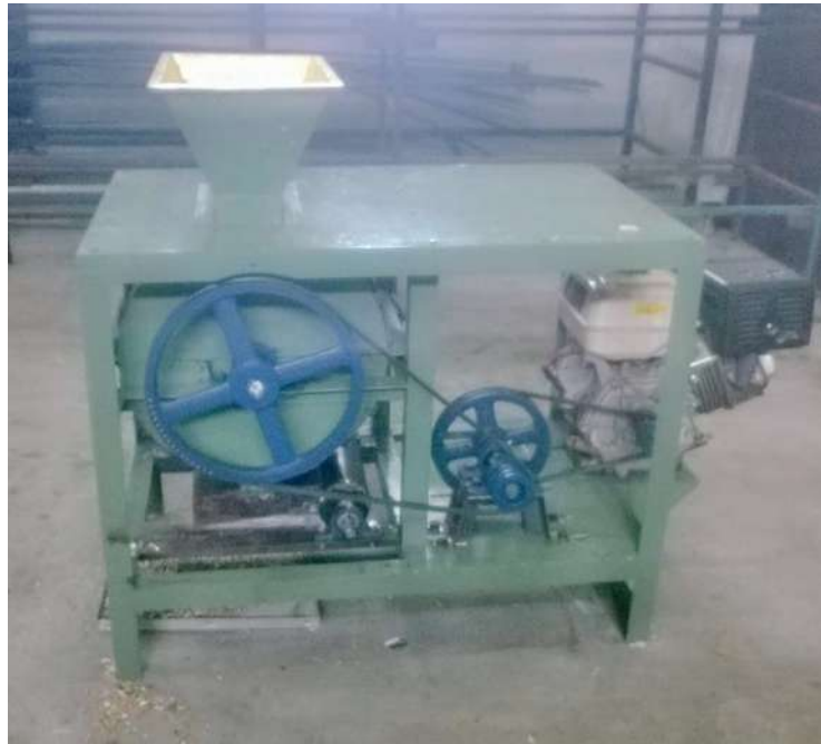
Gambar 2. Hasil Manufacturing : Mesin Pengupas Kulit Kacang Tanah Versi 1
