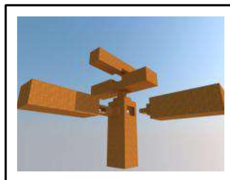
Gambar 4. Simulasi sistem sambungan antara tiang dan balok lantai
