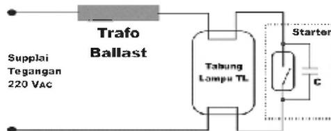
Gambar 1 Diagram lampu TL balas induktor
