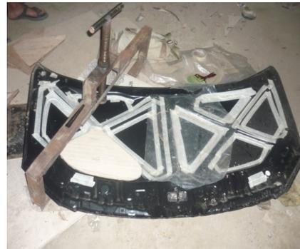
**Gambar 3.** Cetakan dan alat pengunci
