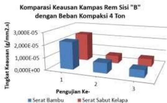
**Gambar 15.** Grafik perbandingan keausan kampas rem sisi B dengan beban kompaksi 4 Ton
