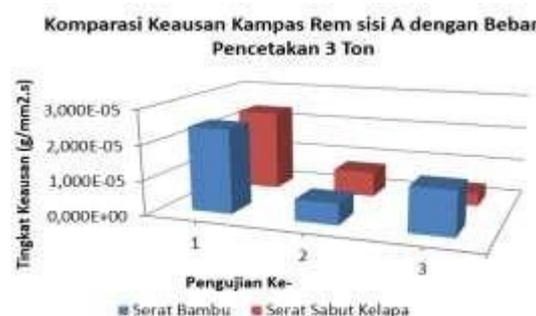
Gambar 11. Grafik perbandingan keausan kampas rem sisi A dengan beban komposisi 3 Ton.
