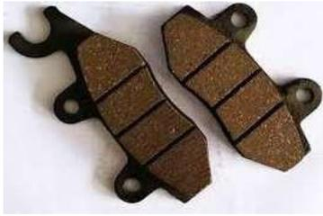
**Gambar 4.** Kampas Rem Asbestos.
