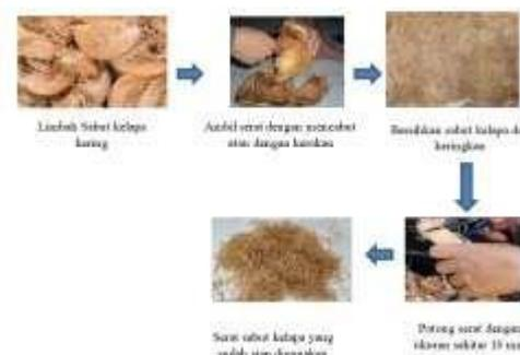
**Gambar 7.** Proses Persiapan Serat Sabut Kelapa
