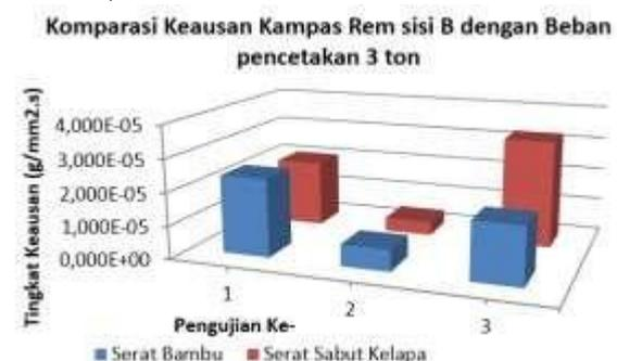
**Gambar 14.** Grafik perbandingan keausan kampas rem sisi B dengan beban kompaksi 3 Ton.
