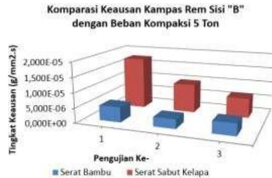
**Gambar 16.** Grafik perbandingan keausan kampas rem sisi B dengan beban kompaksi 5 Ton
