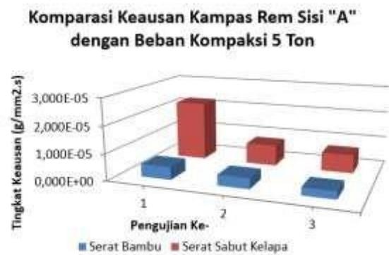
**Gambar 13.** Grafik perbandingan keausan kampas rem sisi A dengan beban kompaksi 5 ton
