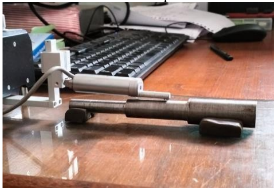
Gambar 3. Proses pengujian Kekasaran HASIL
