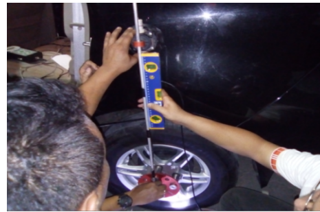
Gambar 11. Pemasangan Tongkat Indikator
